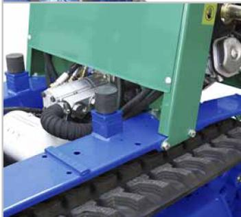
**TRASMISSIONE OLEODINAMICA CON POMPA A INGRANAGGI A TRE CORPI**
